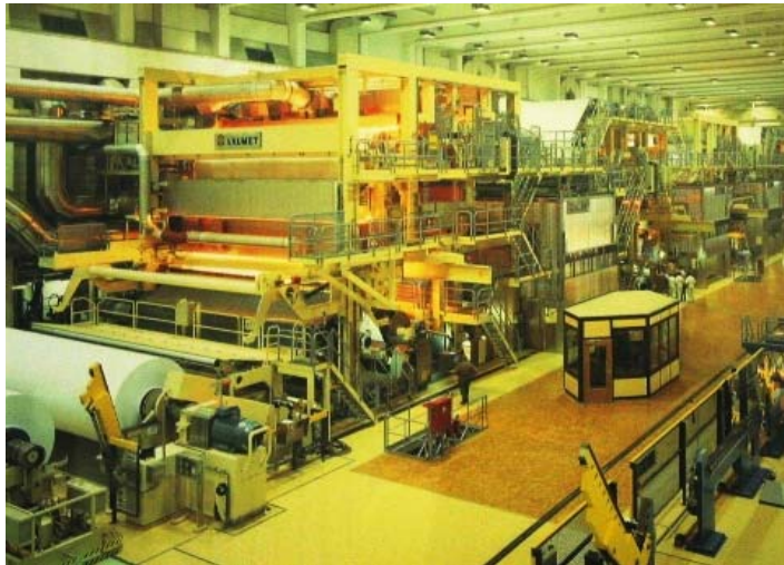
Abbildung 2-17: Streichmaschine SM 2 der Nordland Papier Dörpen GmbH
