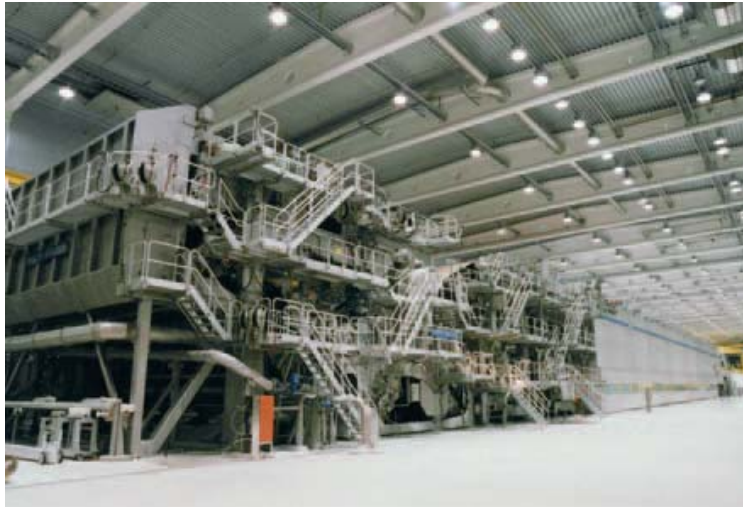
Abbildung 2-13: Papiermaschine mit Former (Voith Paper)
