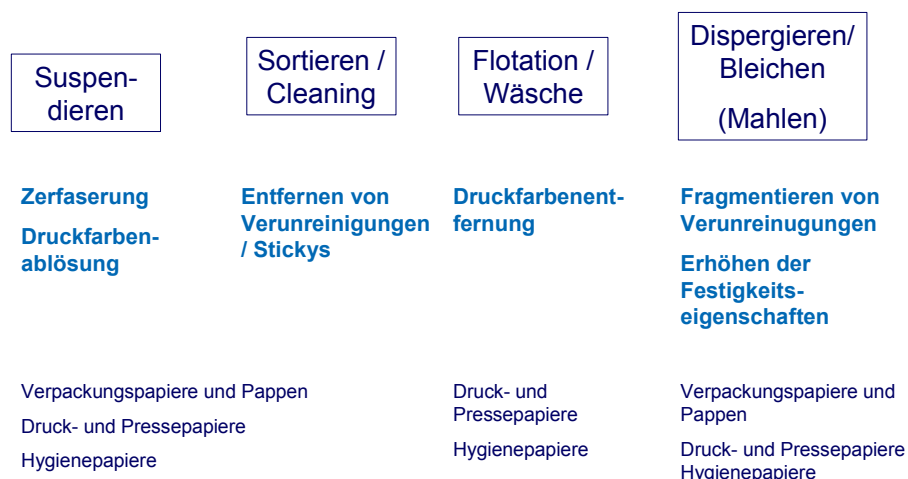
Abbildung 3-5: Prozessstufen der Altpapieraufbereitung [3-4]
