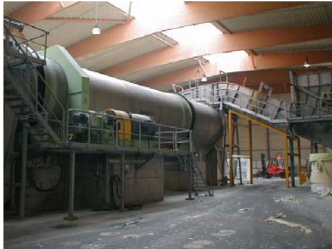
Abbildung 3-6: Hochkonsistenz-Auflösetrommel für Altpapier (Bildquelle: SCA Packaging)
